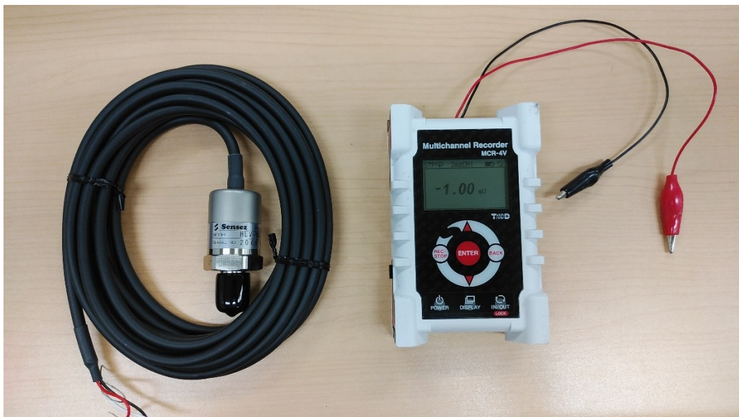
写真 4-5 写真左から，圧電素子型圧力計（東京計測社製）と電圧データロガー（T&D 社製）
