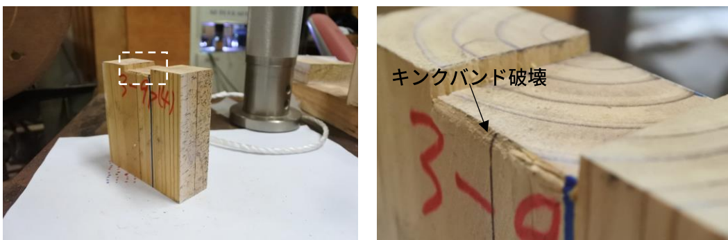
(b) 部分圧縮試験体の破壊
