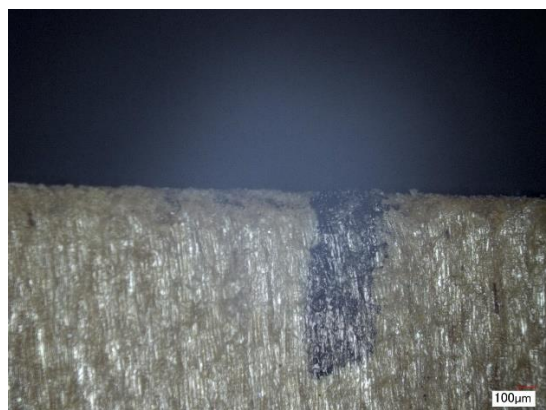
(b) 2.8kN まで加力し除荷した試験体
