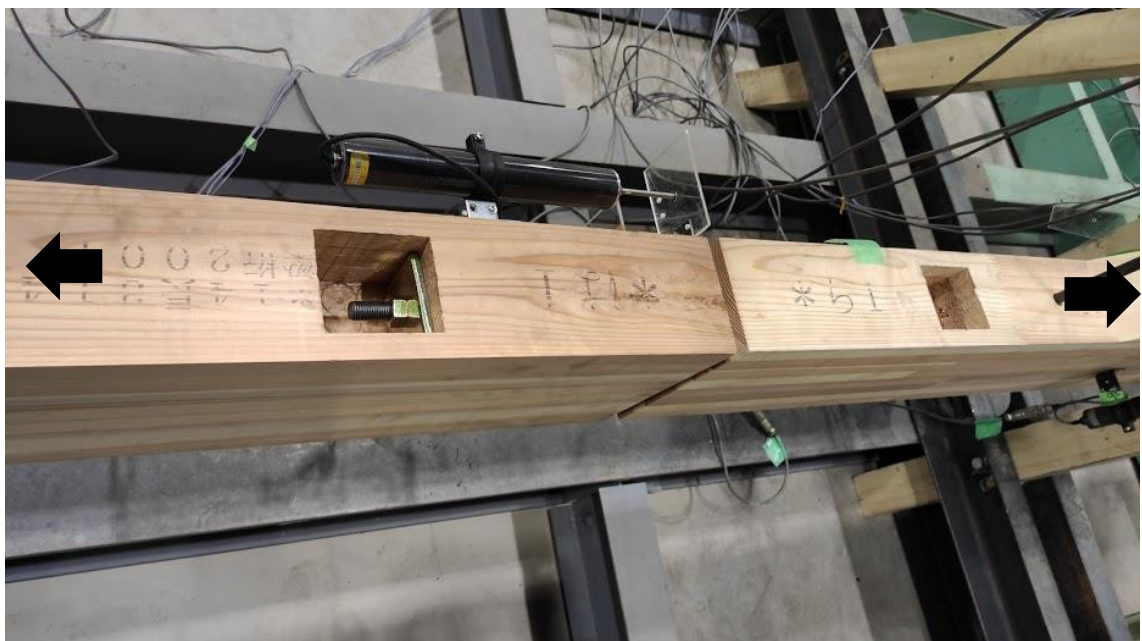
Figure 1.2 引きボルト接合部
