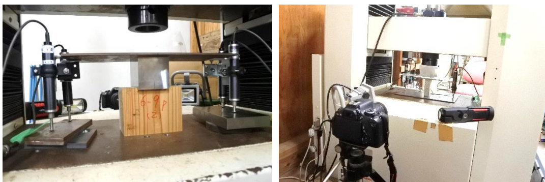
Figure 2.2 加力・測定装置
