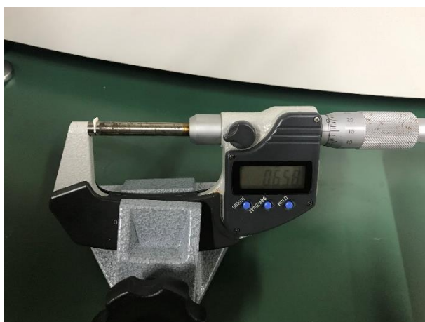
図 6. マイクロメーターを用いた SF 人工血管壁の厚み測定
