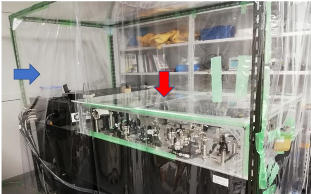
図 3.4 光学系全体を覆うために設計した囲い。詳細は本文に記載。
