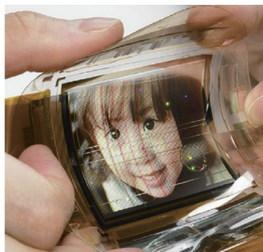
図 1.3 2008 年に開発された OTFT 駆動のフルカラー有機 EL ディスプレイ。(文献 [29] より引用.)
