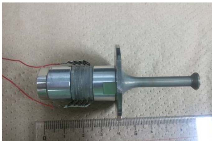
図 1.2 LiNbO 3 単結晶を用いたボルト締めランジュバン振動子 [5]
