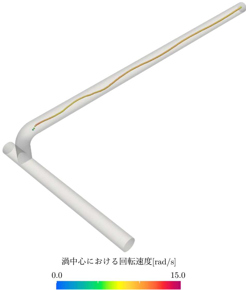
図 3.7 NN モデルによる渦中心位置抽出結果
