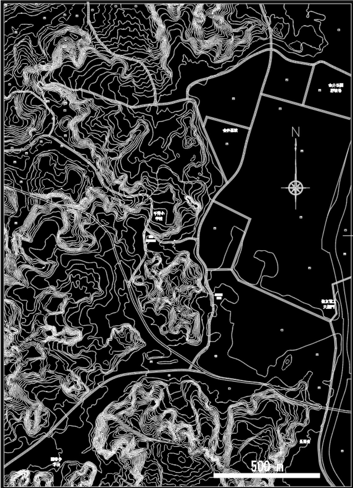
図V-8. 航空レーザ測量に基づく2 mDEMを用いた大型地形模型のCADデータ。
