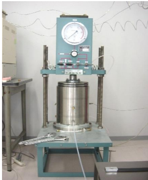
Figure4.1-1.Plastics compression machine (丸東製作所 製)
