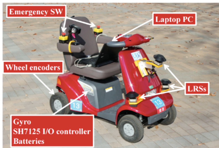
図 1.4 自律移動システムの導入が見込まれる機体：CARTIS TypeR [11]
