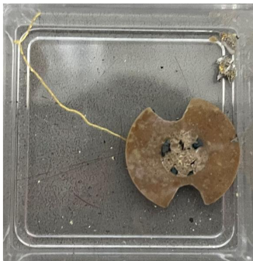
図 2-6 BCY10 セルカソード側(測定後)
