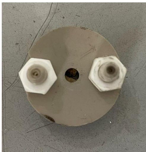
図 2-5 セル固定用セラミック板
