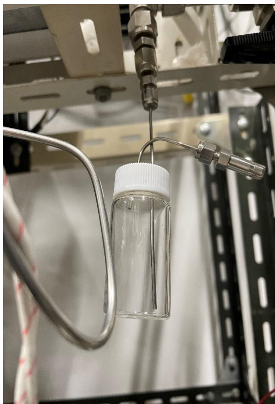
図 2-4 アンモニアの捕集用スクリュー瓶
