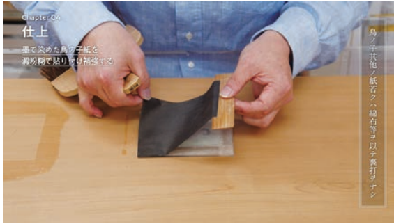
②1 鳥ノ子其他ノ紙若クハ綿布等ヲ以テ裏打ヲナシ 墨で染めた鳥の子紙を澱粉糊で貼り付け補強する
