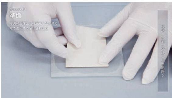
⑦ 後水ニテ右ノ隔紙ノ上ニ貼附シ 写真の画像面と雁皮紙を水で湿らせて貼り合わせる
