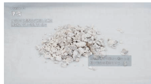
④ 絹布片ニテ包ミタル水蠟膏ヲ イボタロウ貝殻虫が分泌した蠟を雁皮紙と写真の画像層に塗る
