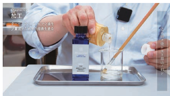
⑫ 【前法】之二的列並油ニ葦麻子油少許ヲ加ヘタルモノヲ塗りターペンタインにヒマシ油を少量混ぜた油性の溶液を塗る
