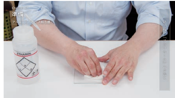
① 硝子板ヲ「アルコール」ニテ洗ヒ(原文、以下同じ) アルコールでガラス板を洗浄(意識、以下同じ)
