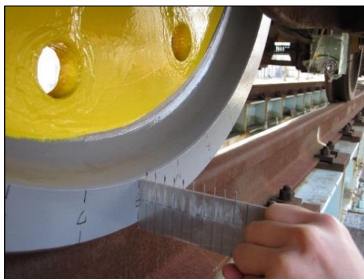
図 7-9 校正目盛りによる車輪とレール間の接触位置の数値化
