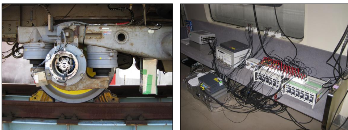
(a) 輪軸端部のスリップリングの仮設状況 (b) 車上に設置した測定機器の状況
