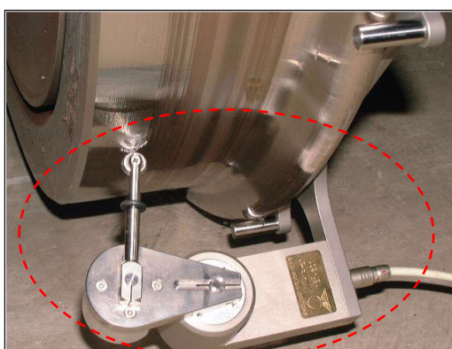
図2-10 デンマーク製の車輪踏面形状測定器 MiniProf “Wheel”
