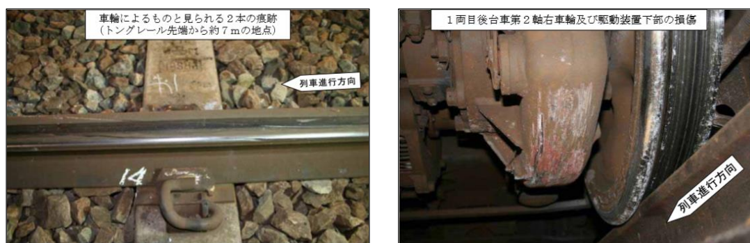
(a) 車輪の乗り上がり走行痕 (b) 脱線後の車輪踏面の状況
