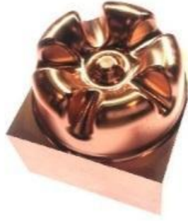
図 3.3 高精度高品位加工のワークピースの例（銅電極）
