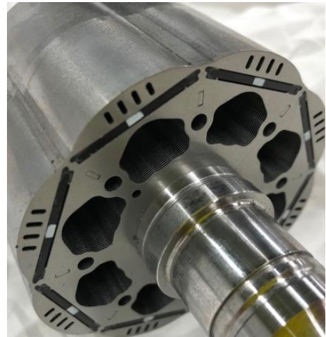
図 2.2 永久磁石を用いたロータ構造の例 (再掲)
