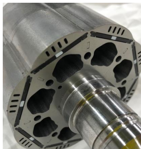
図 1.2 永久磁石を用いたロータ構造の例
