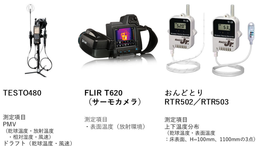
図 5-3-2 実測項目と使用した実測機器
