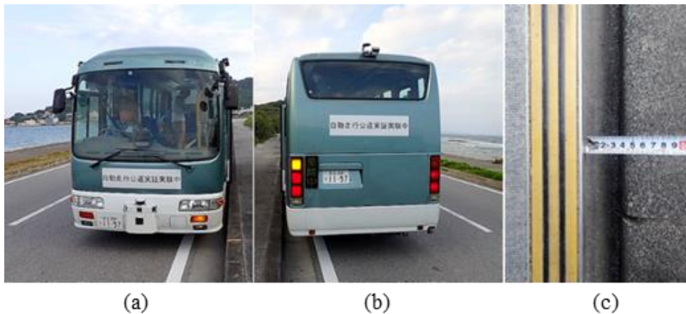
図 6.4.16 正着完了時の様子 (a) 車両前面, (b) 車両後面, (c) 縁石からドアまでの距離
