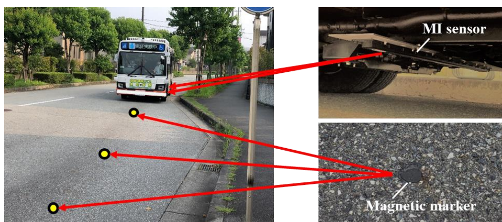
図 6.2.1 実験車両に取り付けられた MI センサと公道に埋設された磁気マーカ
