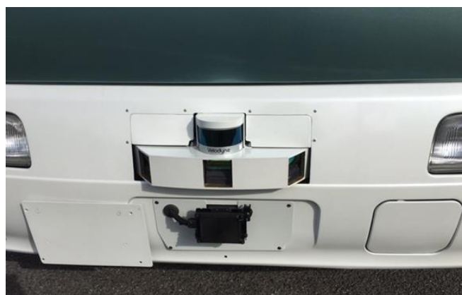
図 2.2.5 車両前方に設置された回転式 3D LiDAR
