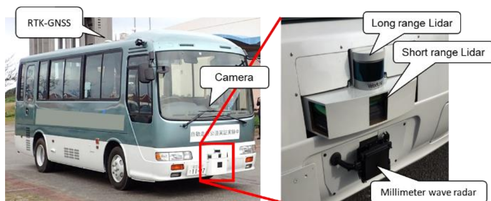
図 6.3.1 縦方向制御に用いる車両およびセンサ
