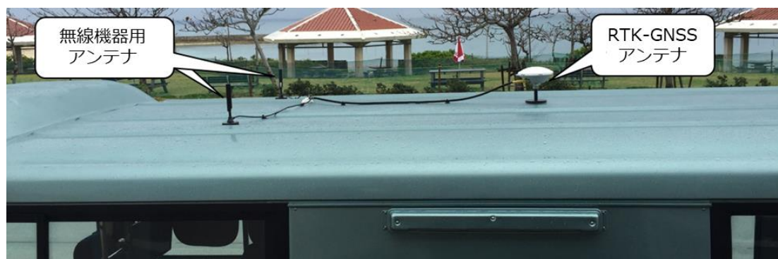
図 2.2.3 RTK-GNSS に必要なアンテナ
