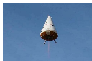
図 1.5: 再使用ロケット実験機 RVT 16) (垂直離着陸形式)
