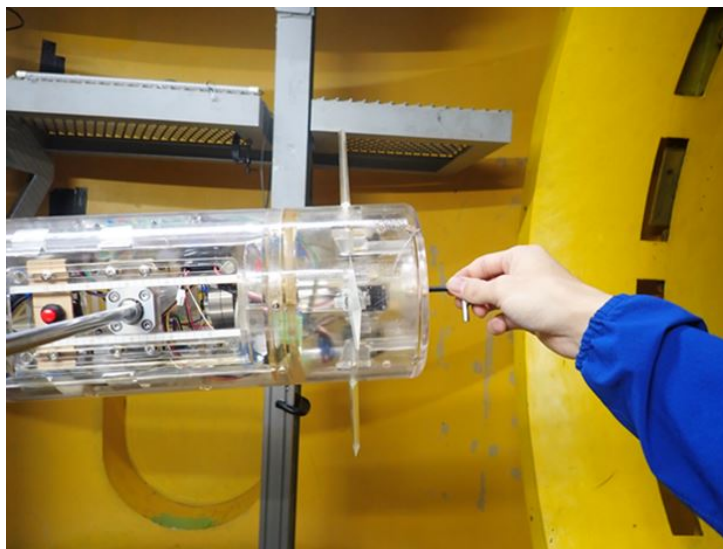
図 3.4: X 軸方向バランスウェイト調整の様子
