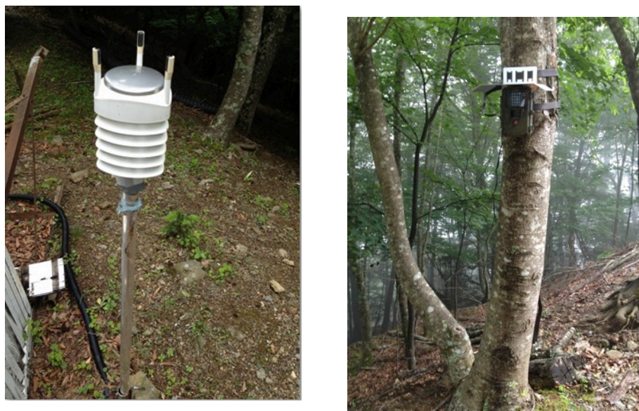
Fig. 1.2.2 東京大学秩父演習林に設置している赤外線カメラと気温センサー[20]
