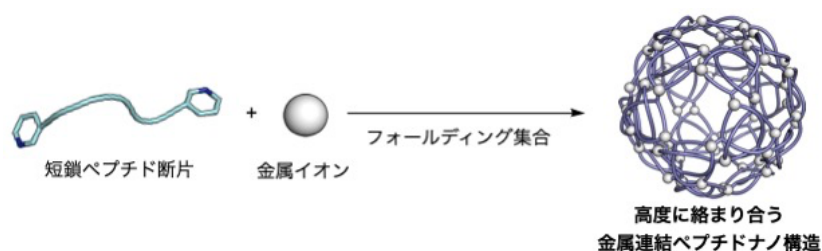
図 1：フォールディング集合法による高度に絡み合う金属連結ペプチドナノ構造の構築。
