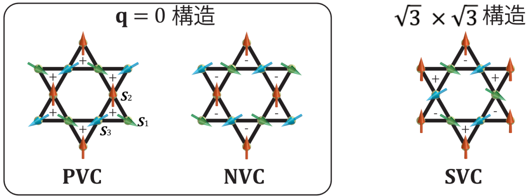
Fig.4.2.2 カゴメ格子における磁気構造。三角形内の符号は、 \mathbf{K}_v の符号を表している。
