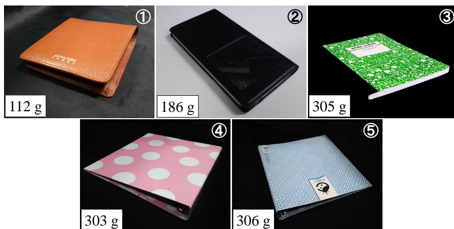
Fig. 6.7: 視覚・近接覚を持つハンドによる把持運搬操作実験の対象物品 [130] . ID 1 から順に、二つ折り財布、フリップカバー付き携帯電話、ノート、ピンクのバインダー、青いバインダー .
