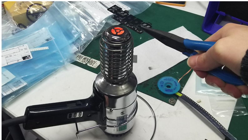
Fig. 5.42: ヒートガンでの炙りによる半田付け [130] .
