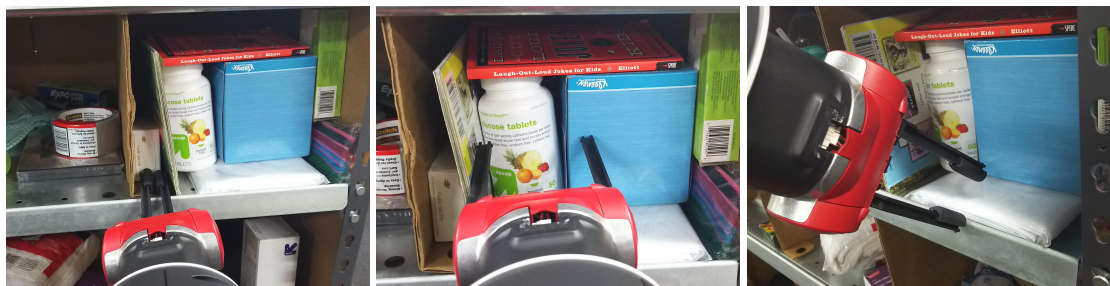
(a) 狭い隙間にある対象物を把握できない . (b) 他物体に囲まれた対象物を把握できない . (c) 他物体の下にある対象物を把握できない .
