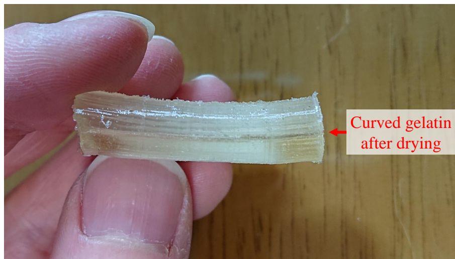
Fig. 4.46: ゼラチン：グリセリン：水 = 1 : 2 : 3 の溶液による造形物の乾燥後の湾曲．
