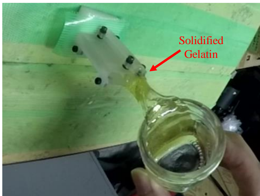
Fig. 4.39: 型の溶液注入口が固まった溶液で塞がった様子 [111] .
