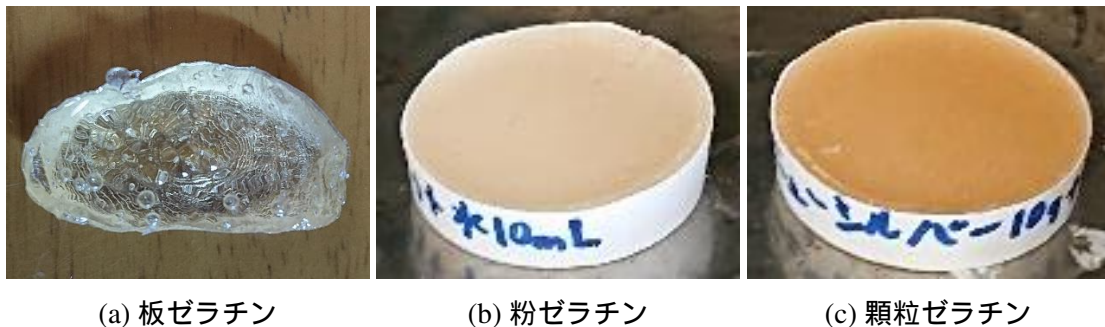
Fig. 4.37: 高濃度ゼラチン水溶液による造形物の透明度に関するゼラチン形状の比較 [111]. 板ゼラチンは気泡を除けば透明であるのに対し，粉・顆粒ゼラチンは完全に不透明である．粉ゼラチンはゼライス株式会社のゼライスゼラチンパウダーを，顆粒ゼラチンは新田ゼラチン株式会社のニューシルバーを用いた．
