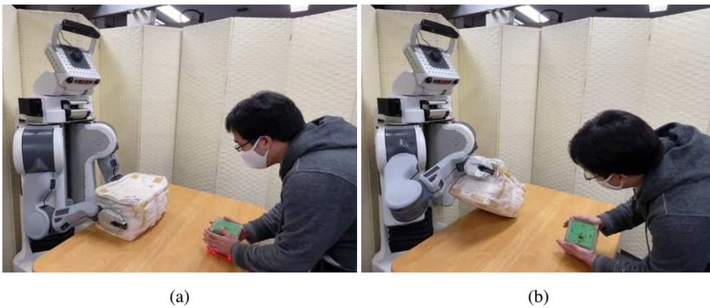
図 4.22: Miniature Tangible Cube による箱傾け作業実験 (X 軸 -45°)
