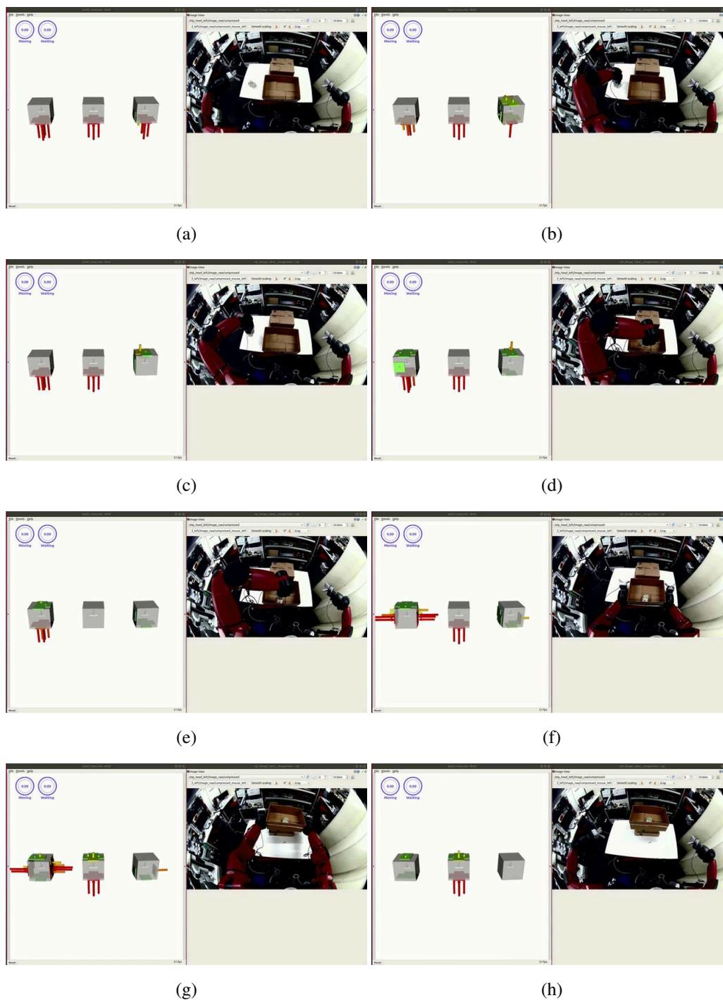
図 4.43: Miniature Tangible Cube によるスポンジのダンボール箱収納作業実験 (操縦者側表示画面)
