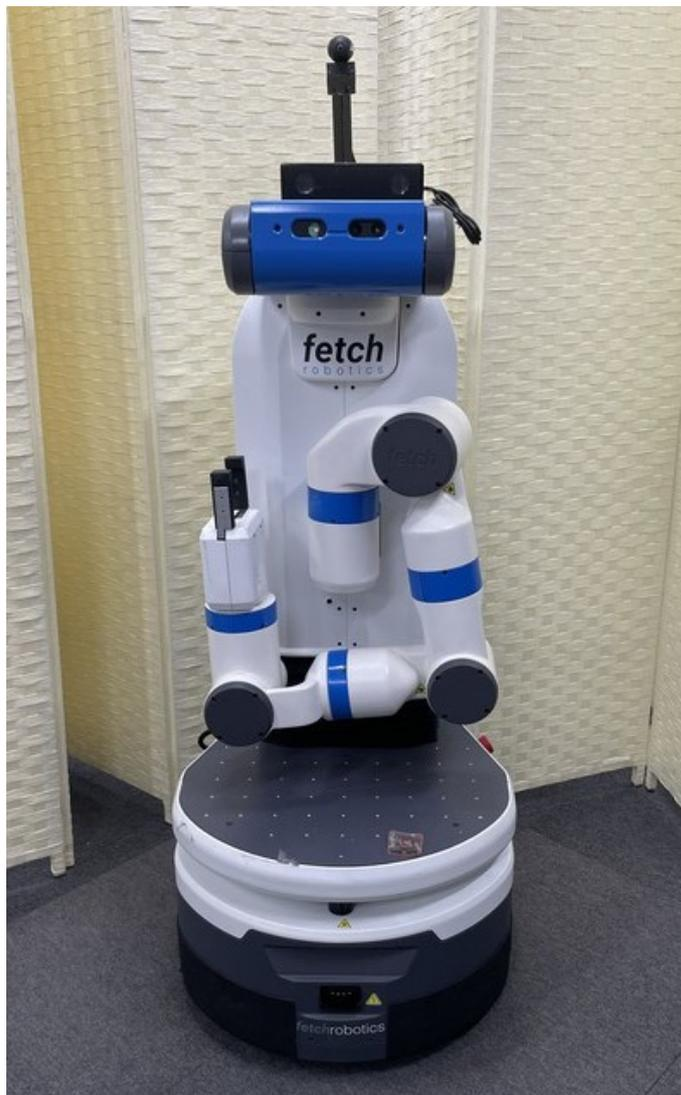
図 3.13: 単腕移動ロボット Fetch-JSK
