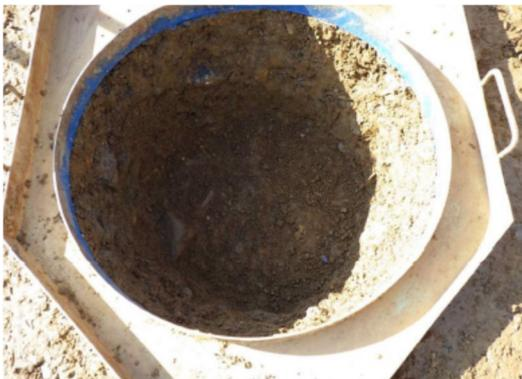
水置換法\_削孔完了 (中層)
