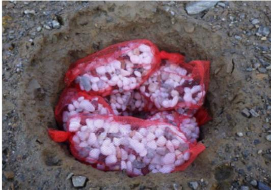
現場透水試験（孔壁保護石充填）
