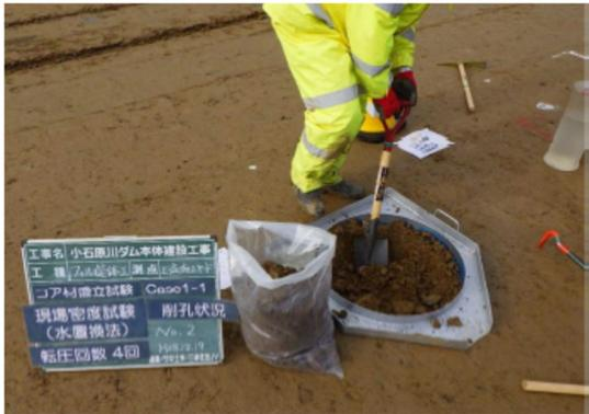
水置換法\_削孔状況
