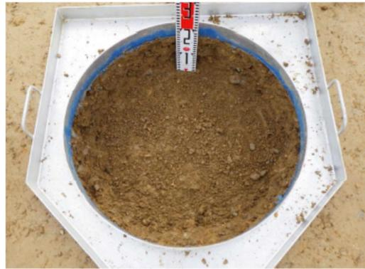
水置換法\_削孔完了 (表層)
