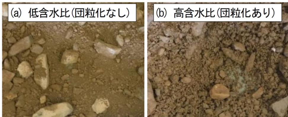
写真-5.3 含水状態による団粒化の影響（同一粒度）
