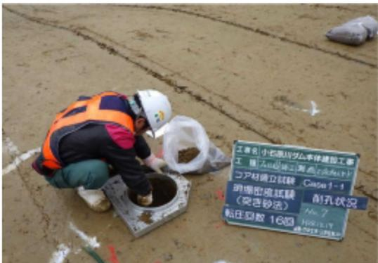
現場密度試験（突き砂法）削孔状況
