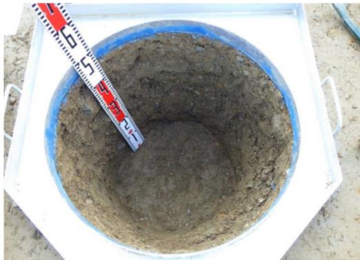
水置換法\_削孔完了 (深層)
