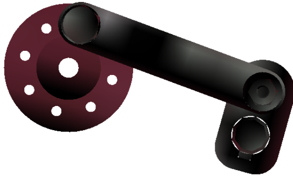
Fig. 13: 翼回転用 Tilt 機構
