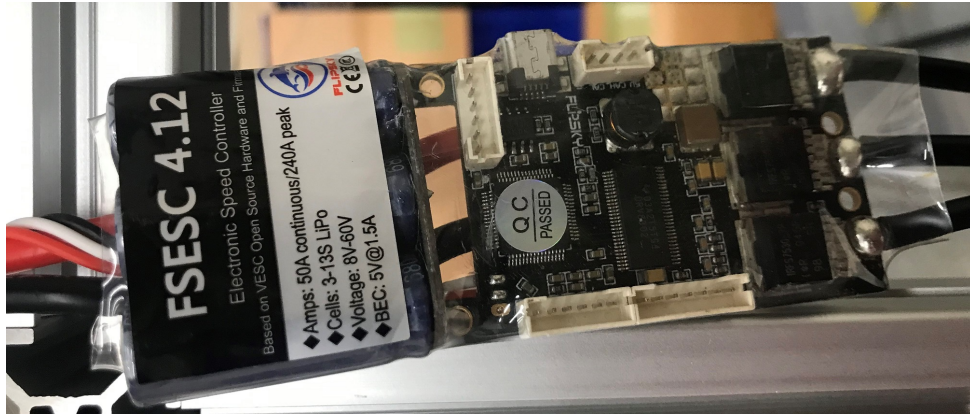
Fig. 14: VESC に基づいた ESC
