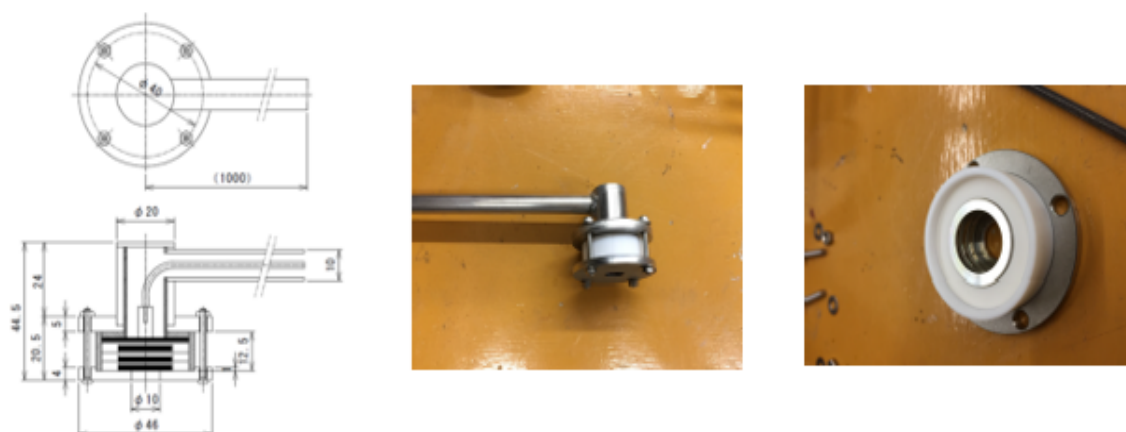
図 2.2: 左図：ワッシャーガン設計図。中央図：ワッシャーガン外観。右図：ワッシャーガン内観。
