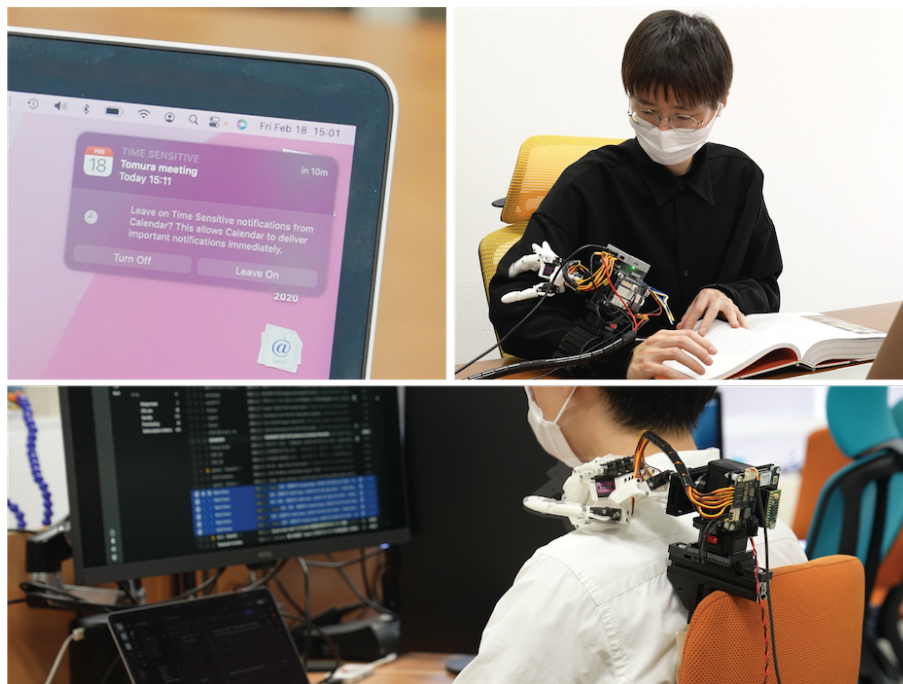
図 6.7: 通知：(上) カレンダーの通知が届くと、触覚刺激により装着している人に次の予定を知らせる。(下) メールが届くと、肩を叩いて通知する。
