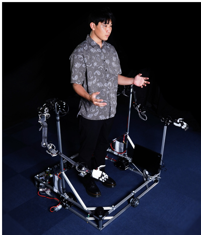
図 5.1: 物理的な接触なしにユーザーと座標を共有する Human Coincident Robot (HCR) の概念実証プロトタイプ。HCR に搭載された 2 つのロボットアームの内部で人間が動くことができる。
