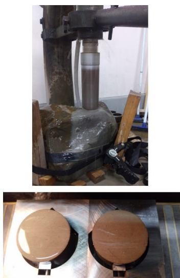
図 3.2 試料の作成に用いたボーリングマシン(a)および作成された試料(b)
