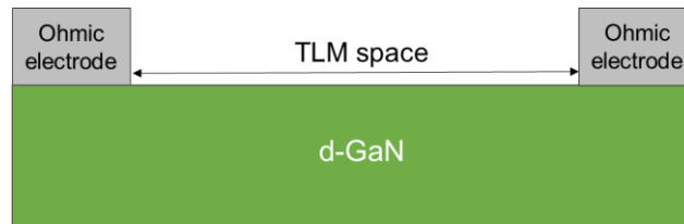
図 4- 3. d-GaN の TLM パターン模式図
