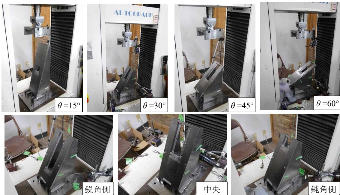
図 2-4 天板の角度調整とほぞ受け位置調整
