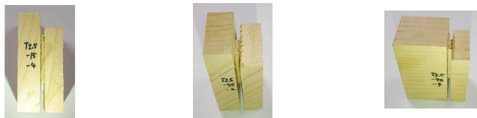
図 3-18 各シリーズの代表的な破壊状況
