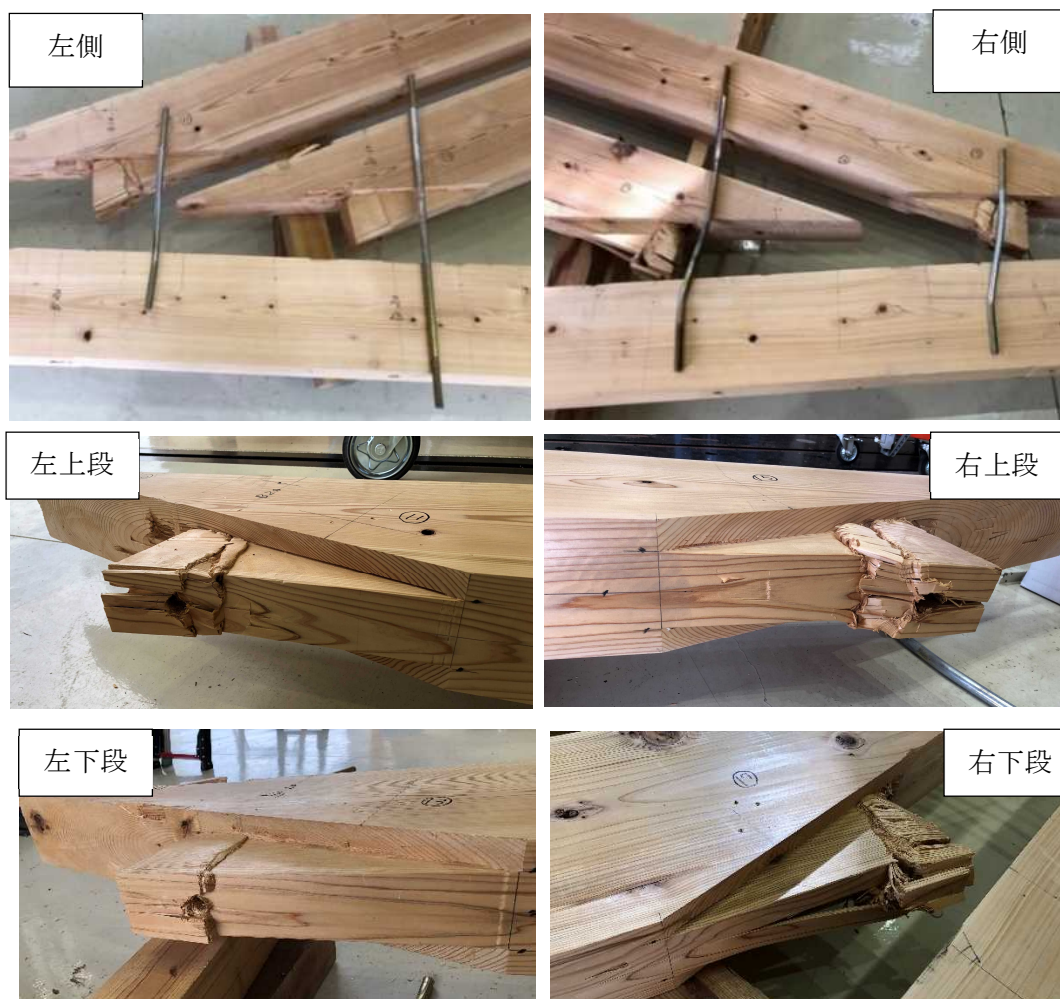
図 4-15 合掌尻ほぞの破壊状態
