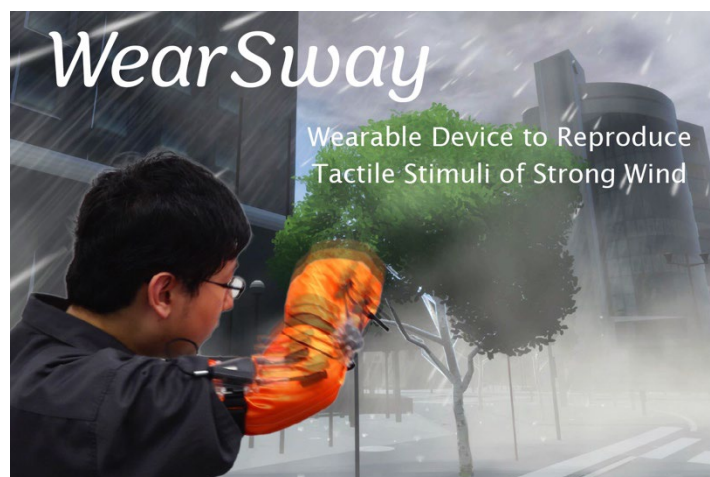
図 C 強風による衣服の振動を再現する装置 WearSway
