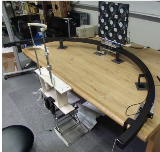
図 2.1: 中野ら [44] が風向の JND 測定に用いた装置
