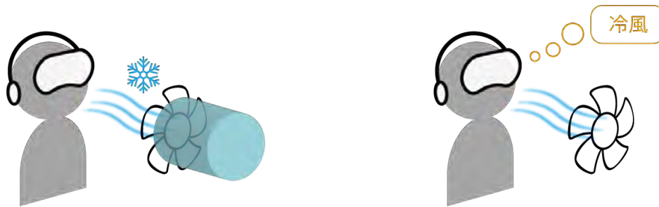
図 2.11: 風温知覚変化のメリット. (左) 物理的な風のみで風温を再現する風覚ディスプレイ (右) 風温知覚変化を活用した風覚ディスプレイ
