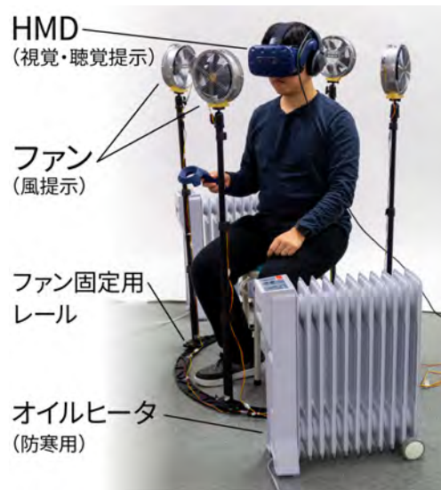
図 3.4: 風向知覚変化検証実験に用いた送風装置 [22]
