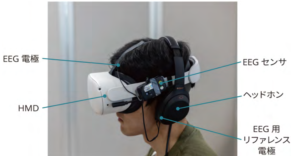
図 6.6: 頭部に HMD, ヘッドホン, 脳波計を取り付けた様子 ©2023 IEEE
