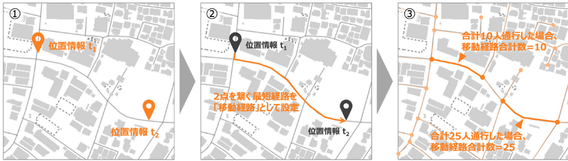
図 3-9. ポイント型流動人口データを用いた歩行者通行量の推定方法
