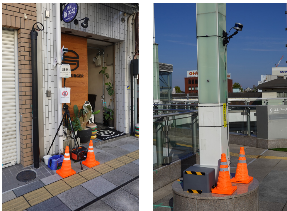
図 2-2. LiDAR 設置の様子 (左: 松山市, 右: 柏市)
