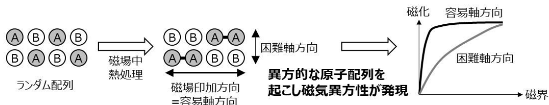
図 2.12 非晶質金属の誘導磁気異方性の発現メカニズム
