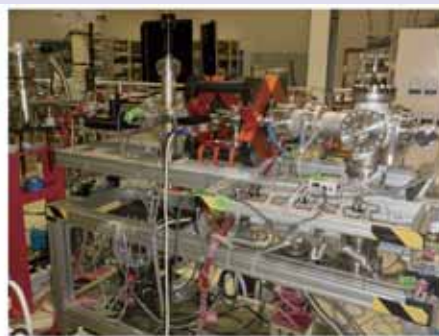
(左) X線天文観測衛星XRISMによるX線連星「はくちょう座X-3」のスペクトル。右上に天体の想像図を示す(クレジット：NASA's Goddard Space Flight Center)。(右) 宇宙科学研究所が所有するプラズマ実験装置。大型放射光施設SPring-8での実験中の様子。装置内に鉄のイオンを生成し、放射光との相互作用を調べた
