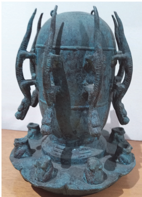
図 34 張衡の地動計（レプリカ）と内部構造
