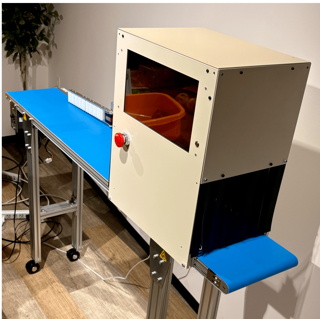
図 4.2: 開発した農作物撮影機械.
