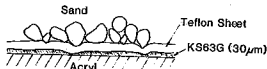
図 16 タイプ1における砂粒子の(テフロンシート+グリース)層への貫入の模式図
