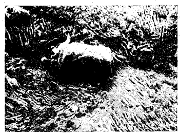
図 2 (a) 複合ラップ定盤表面 (SD # 2000 7.5 wt, カーボニル 22.5 wt% 含有)
