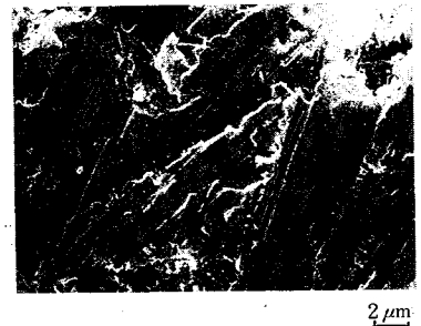
図9 アルミナセラミックラップ面 (ND # 1000 複合ラップ定盤使用)
