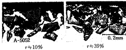
図9 圧下率の変化による強化粒子の圧入状態の相違
