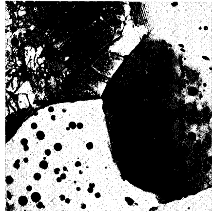
写真1 液体急冷した Al-5% Sn 合金の組織。粒内に球状の析出相、粒界には楕円状の、粒界三重点には三角形に見える析出相がある。
