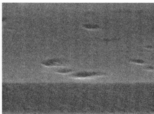
図 3.7 冷却水温度を10Cにした時の酸化アルミと酸化チタンの混成膜のSEM像 (混成膜の表面に窪みが減っているのがわかる)
