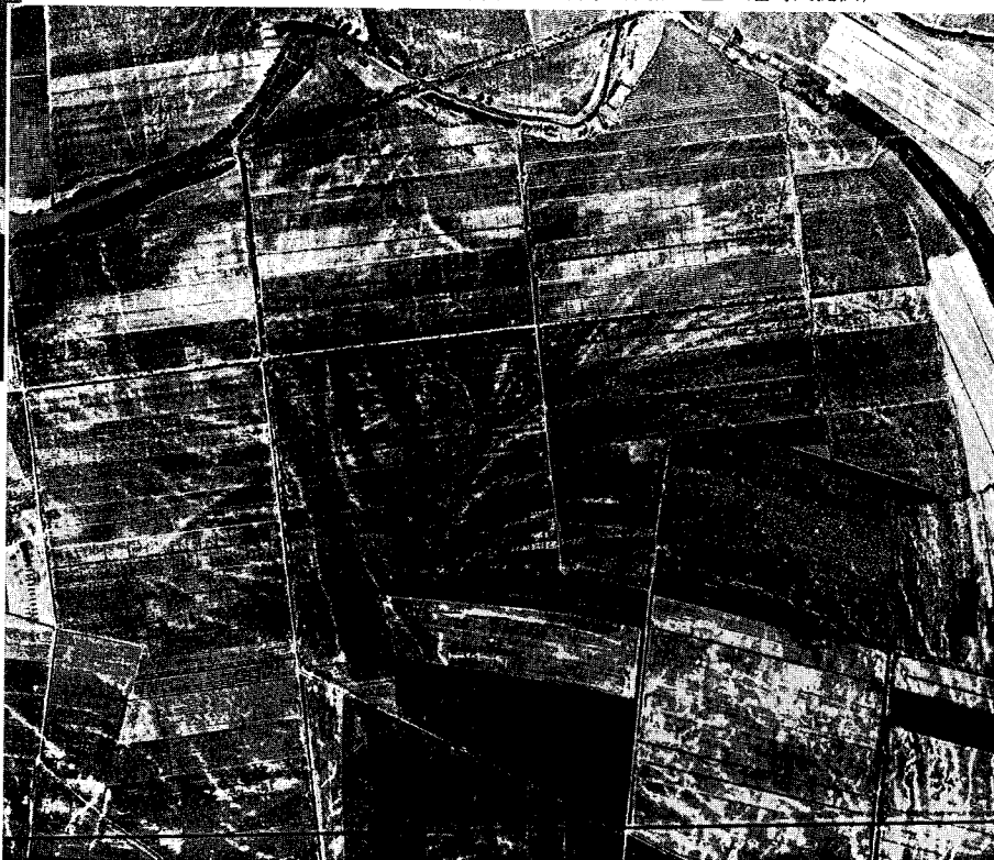
▼写真13 唐山地震における旧河道跡の噴砂（写真中の白い帯の部分） (中国建築科学研究院 王 鐘琦氏提供)
