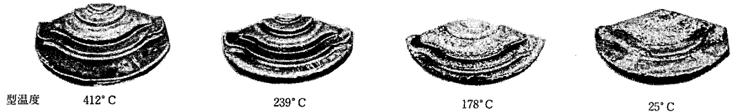
写真4 型温度による影響 ( V_p = 20\% , \phi_c = 70\% , p = 17.4 \text{ kg/mm}^2 )
