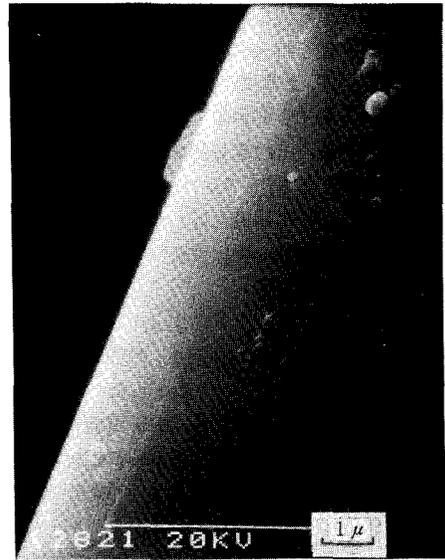
写真4 写真3と同じ処理をした CemFIL® の表面
