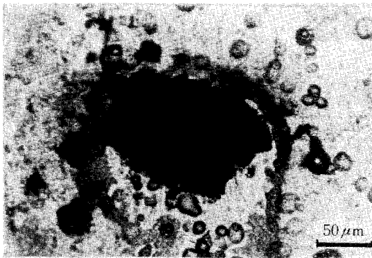
図-3 孔食部拡大図 (試験番号 F1)
