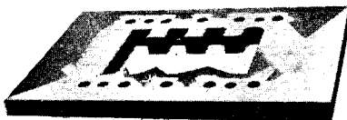
図17 レーザー切断された抜き型構成部品 9)
