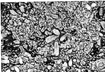
写真-4 空中養生したコンクリート(中性化部分, 2,200倍)
