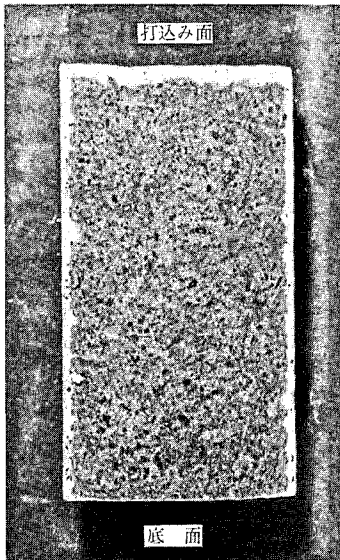
写真-3 スラグ石こうセメントコンクリートの中性化深さうな方法を講ずることが考えられる。
