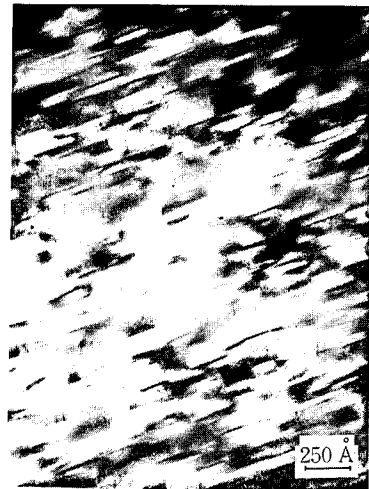
80°C×90 min stress aging +155°C×1000 min
