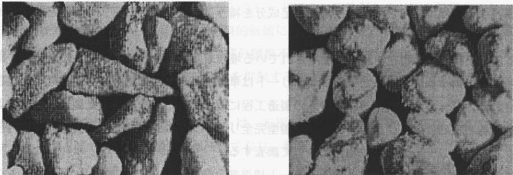
図 5.3.1 汎用型石灰石砕砂と粒形改善型石灰石砕砂（粒径 0.6-1.2mm）
